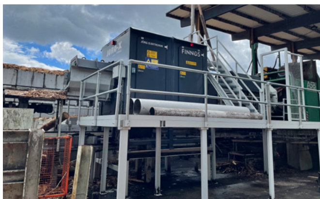
Das Beste aus beiden Welten, vereint auf einer Anlage. Der Joro-X, wie hier bei Holzwerk Schilling, vereint eine 3D-Messung von Jörg Elektronik mit einer Röntgeneinheit von Finnos
